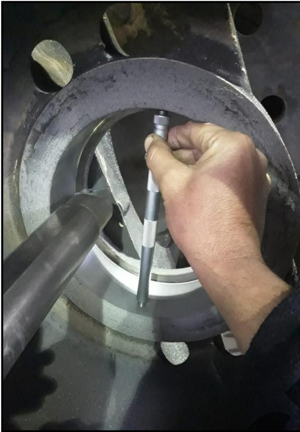
Componente en etapa de rectificado donde se obtiene los diámetros requerido por cliente.
