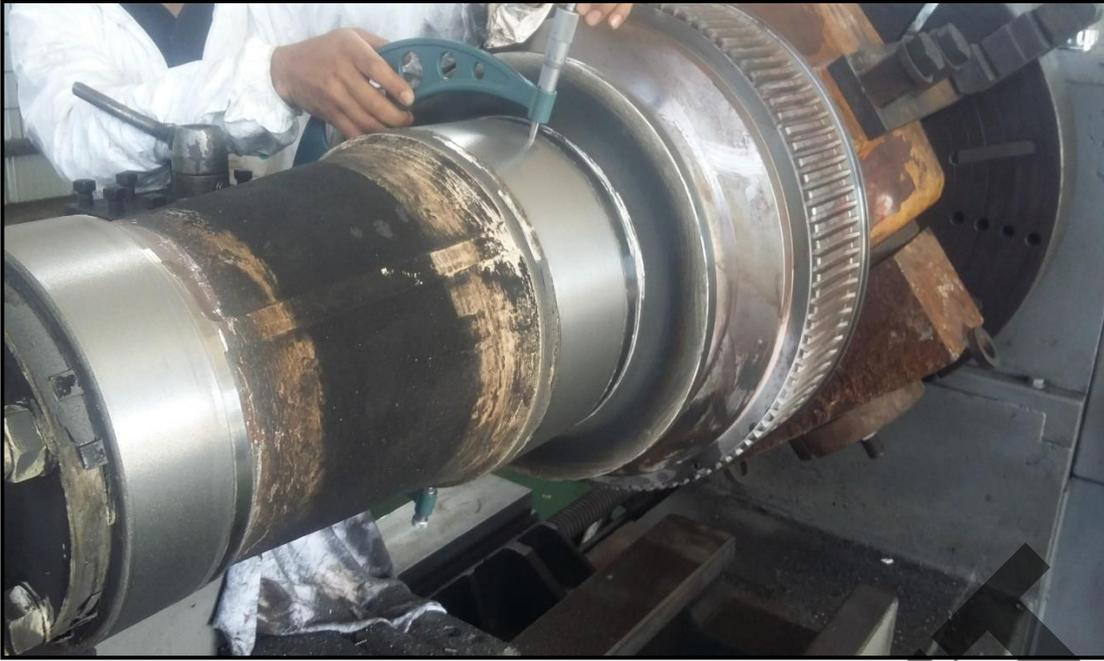
Componente en etapa de rectificado donde se obtiene los diametros requerido por cliente.
