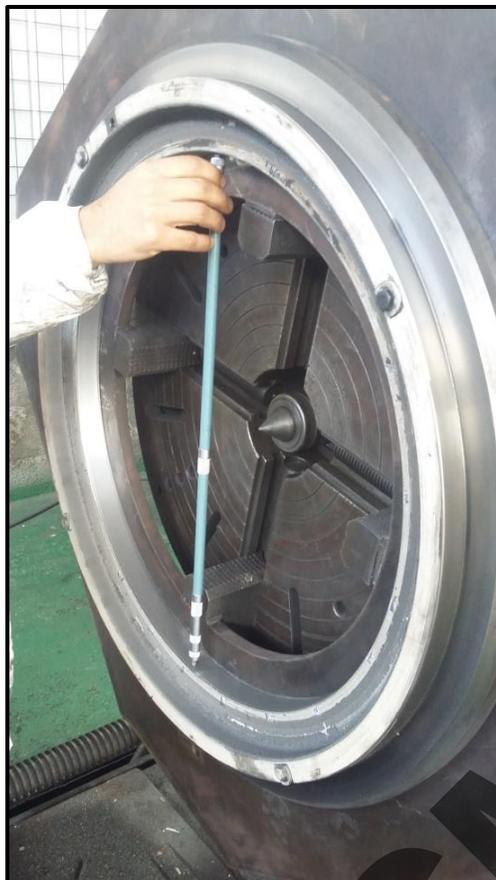
Componente en etapa de rectificado donde se obtiene los diámetros requerido por cliente.
