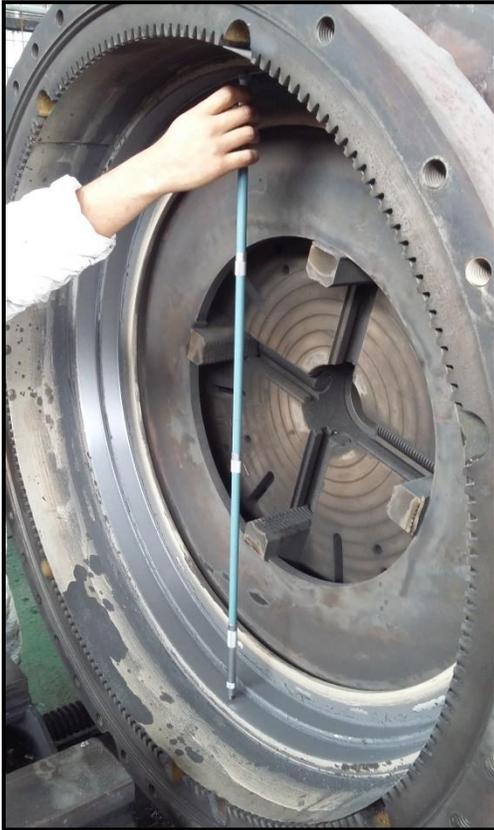
Componente en etapa de rectificado donde se obtiene los diámetros requerido por cliente.
