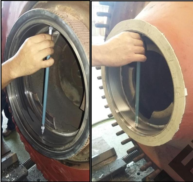
Componente en etapa de rectificado donde se obtiene los diámetros requerido por cliente.
