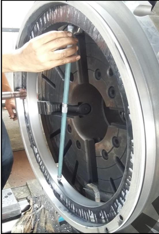
Componente en etapa de rectificado donde se obtiene los diámetros requerido por cliente.
