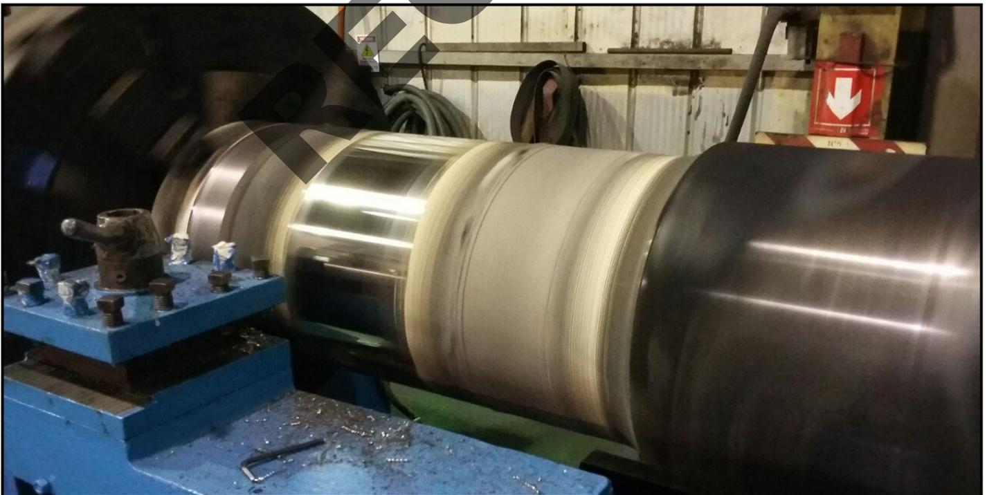
Componente en etapa de rectificado donde se obtiene los diametros requerido por cliente.
