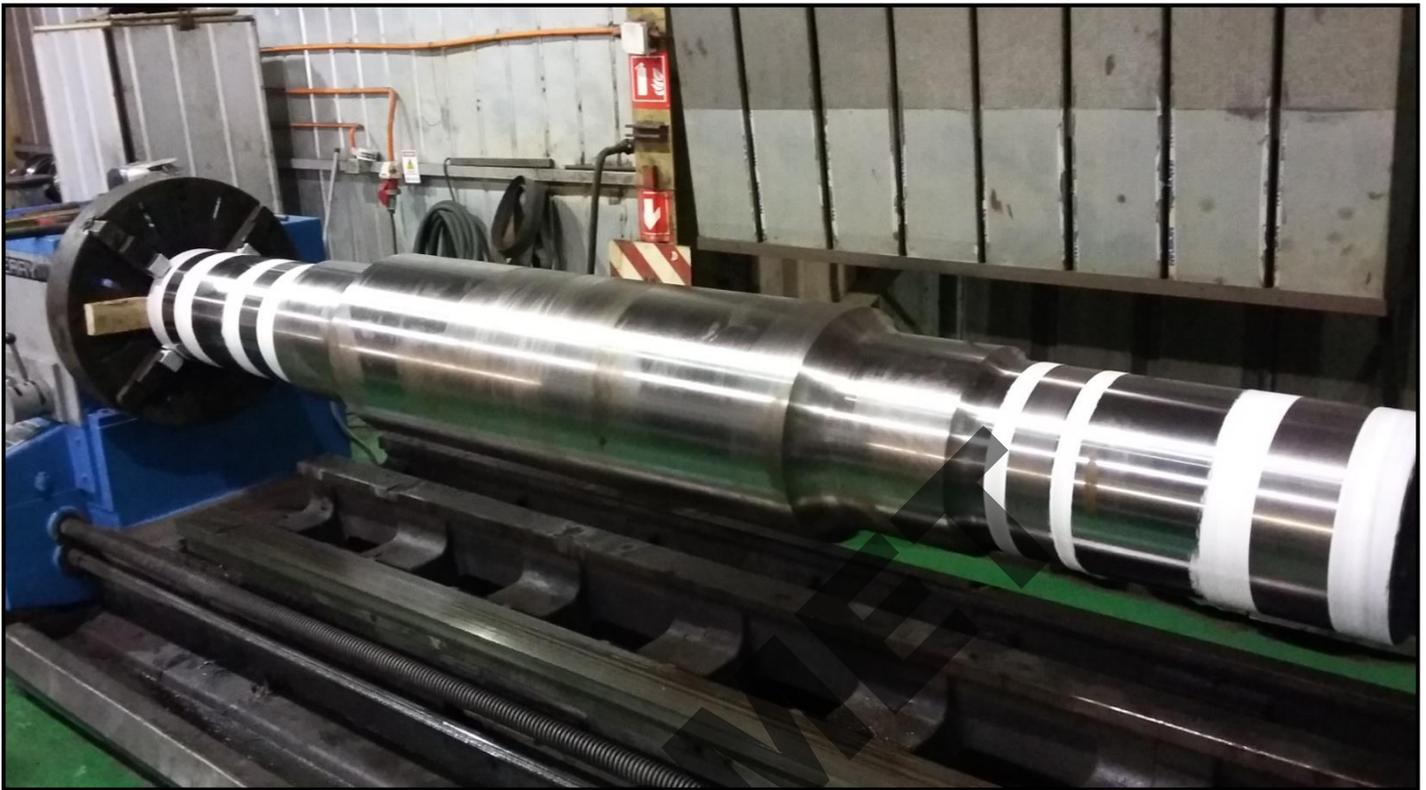
Componente sometido a proceso de Metalizado, posterior mecanizado.
