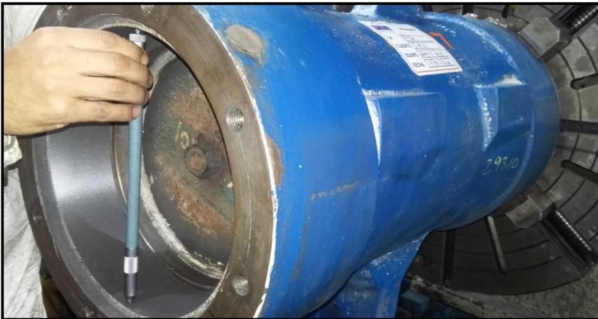
Componente en etapa de rectificado donde se obtiene los diámetros requerido por cliente.
