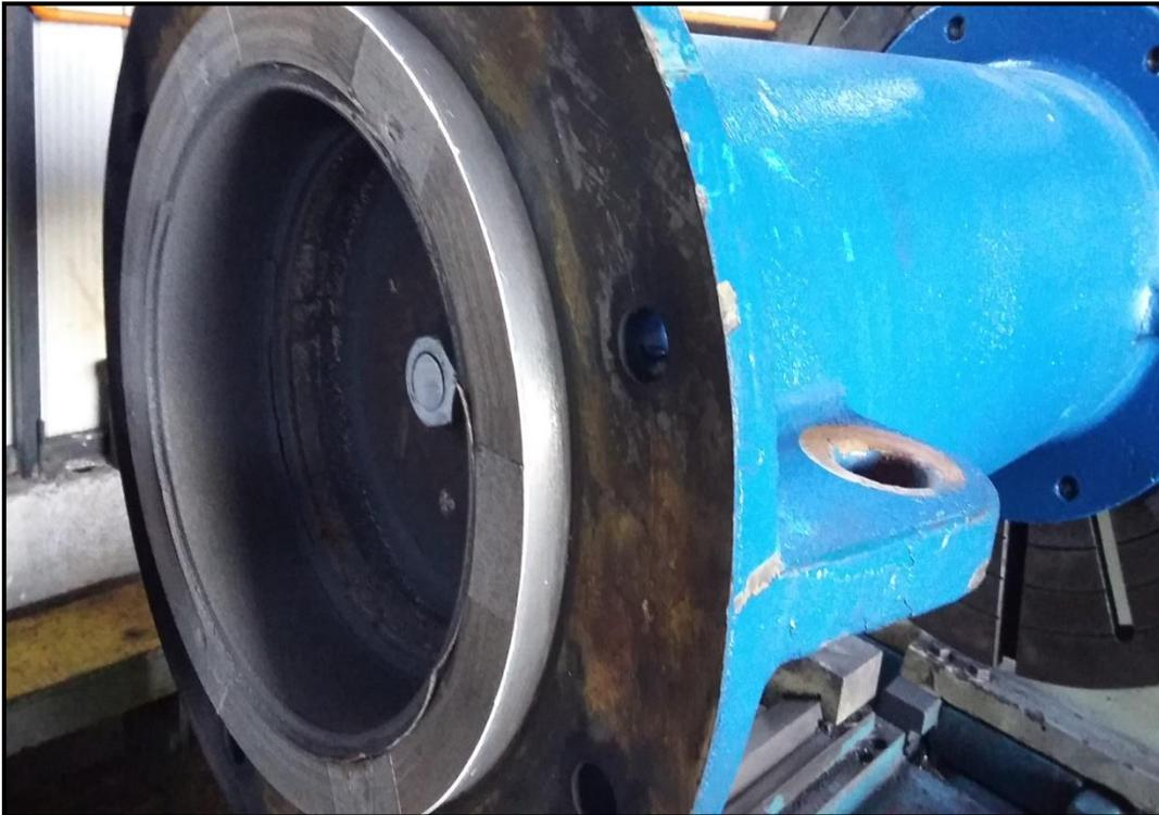
Componente sometido a proceso de Metalizado, posterior mecanizado.
