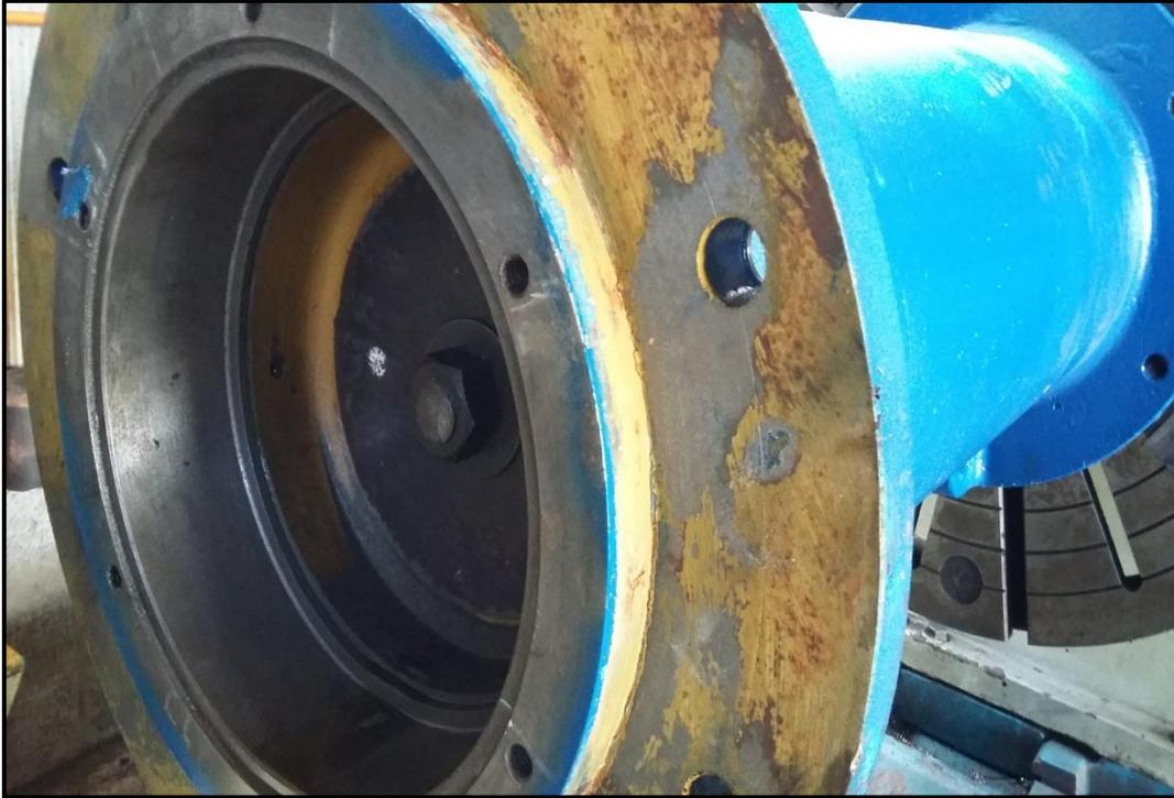
Componente entra en el área para su evaluación, mecánica donde se detecta desgaste en pista de rodamiento.
