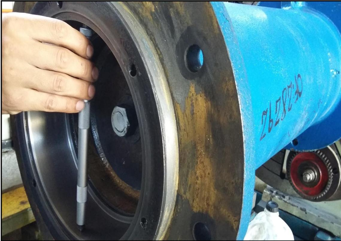
Componente en etapa de rectificado donde se obtiene los diámetros requerido por cliente.
